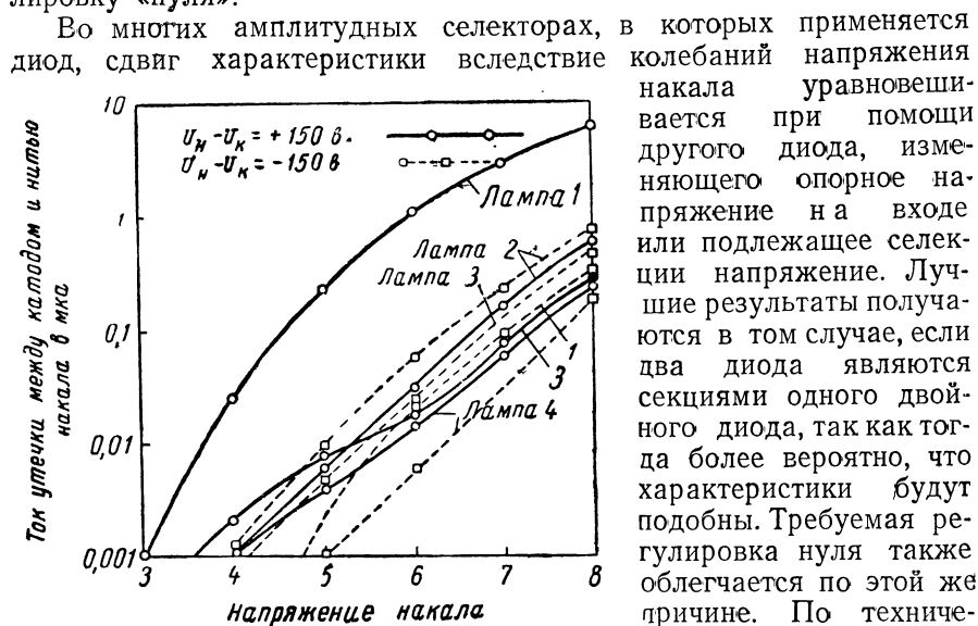
Рис. III.31. Влияние температуры катода на утечку между катодом и подогревателем диода. Одна половина каждой из четырех ламп 6Н6.
